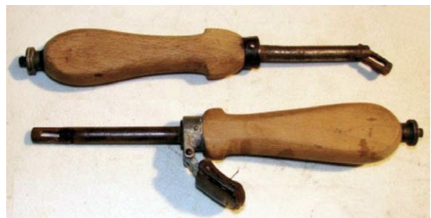
Ryc. 10. Oryginalny odwijak drutu telefonicznego typu pierwszego (źródło: http://firstwartechnik.free.fr/Dtorn.html )
