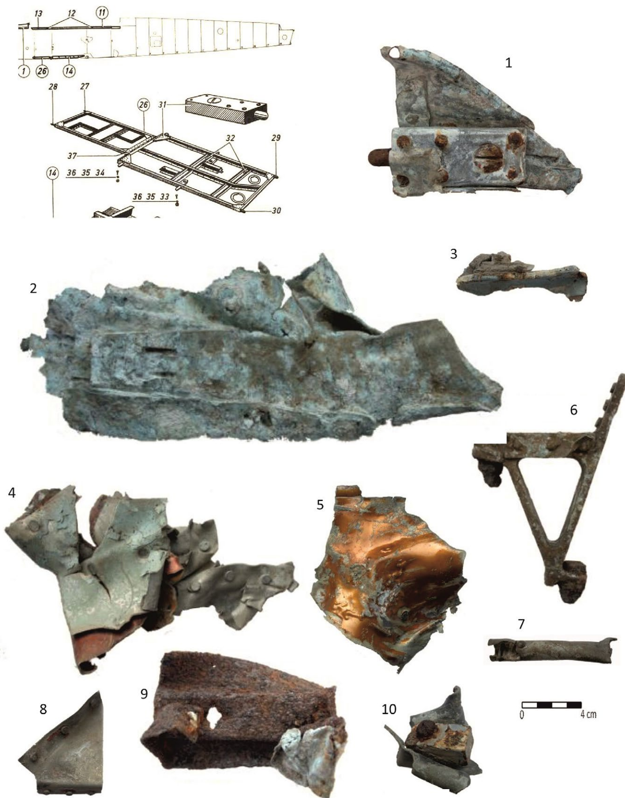
Ryc. 17. Nadma, stan. 12, gm. Radzymin, woj. mazowieckie. Obiekt 200. Elementy konstrukcji samolotu Messerschmitt Bf 110 B. (1) zamek pokrywki luku w podłodze kadłuba (obok rysunek techniczny umiejscowienia części); (2-3) pokrycie i mocowanie dołu kadłuba; (4-5) poszycie wnęki podwozia na spodzie gondoli; (6) wspornik; (7) rurka nitowana; (8) wspornik zabudowy kadłuba (sygnatura „R252”); (9-10) element konstrukcyjny wnętrza kadłuba
