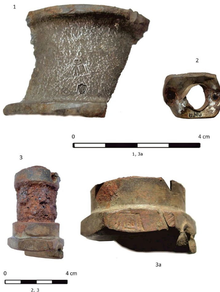
Ryc. 49. Nadma, stan. 12, gm. Radzymin, woj. mazowieckie. Elementy instalacji uzbrojenia Messerschmitta Bf 110 B. (1) aluminiowy fragment jarzma mocującego karabin MG 17 (ar 1654); (2) aluminiowa ramka przełącznika uzbrojenia (ar 2203); (3) mosiężno-stalowy zawór sprężonego powietrza (obiekt 200 A); (3a) punca odbioru technicznego (Luftwaffenamt 58)
