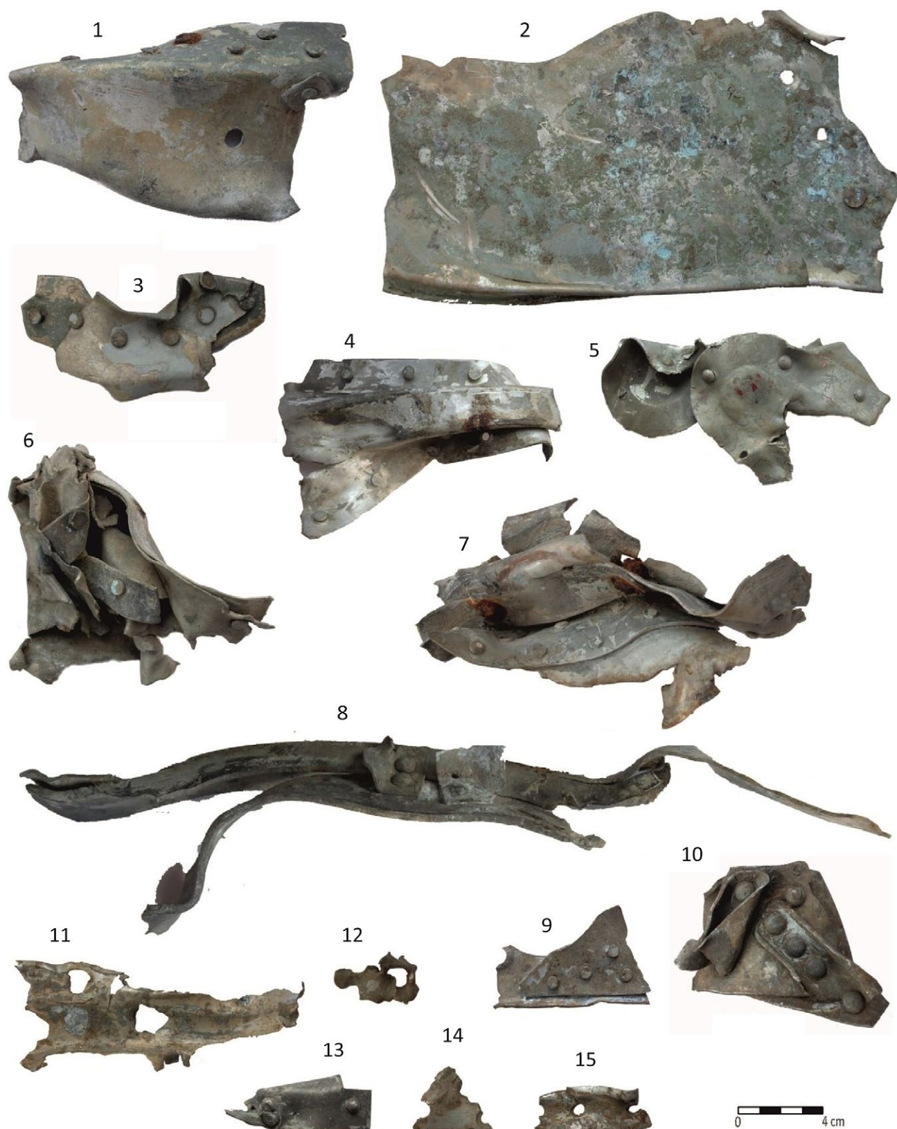
Ryc. 16. Nadma, stan. 12, gm. Radzymin, woj. mazowieckie. Elementy konstrukcji samolotu Messerschmitt Bf 110 B. (1-2) pokrycie kadłuba (obiekt 200); (3) mocowanie warstw pokrycia (ar 1665); (4-8) wewnętrzne poszycie kadłuba (obiekt 200); (9-10) konstrukcyjne połączenia nitowane (obiekt 200 A, ar 1684); (11-12) przestrzeliny w blachach pokrycia (ary 1645, 1654); (13-15) pokrycie skrzydła (ar 1635)
