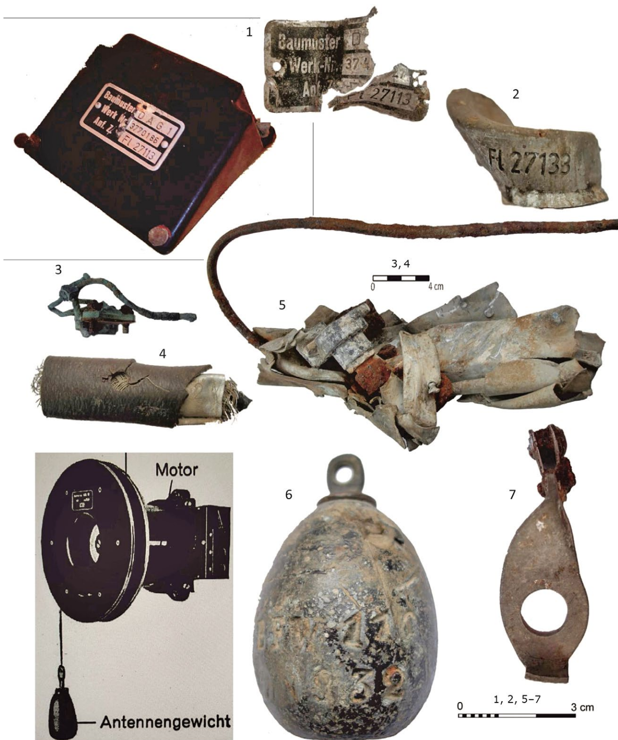
Ryc. 41. Nadma, stan. 12, gm. Radzymin, woj. mazowieckie. Wyposażenie radiowe samolotu Messerschmitt Bf 110 B. Elementy zespołu antenowego. (1) tabliczka znamionowa sprzęgacza anteny radiostacji (obiekt 200 A), obok zdjęcie urządzenia; (2) element układu antenowego sygnowany „FL 27133” (ar 1673); (3) złącze anteny (obiekt 200); (4) kabel antenowy w oplocie i izolacji (ar 1685); (5) fragment układu antenowego z destruktem poszycia (obiekt 200); (6) obciążnik linkowej anteny zewnętrznej, wypuszczanej – wleczonej, sygnowany „BFW 110” i „W.N. 932” (ar 1635), obok rysunek techniczny wciągarki z obciążnikiem; (7) mocowanie naciągu anteny stałej (obiekt 200 A)
