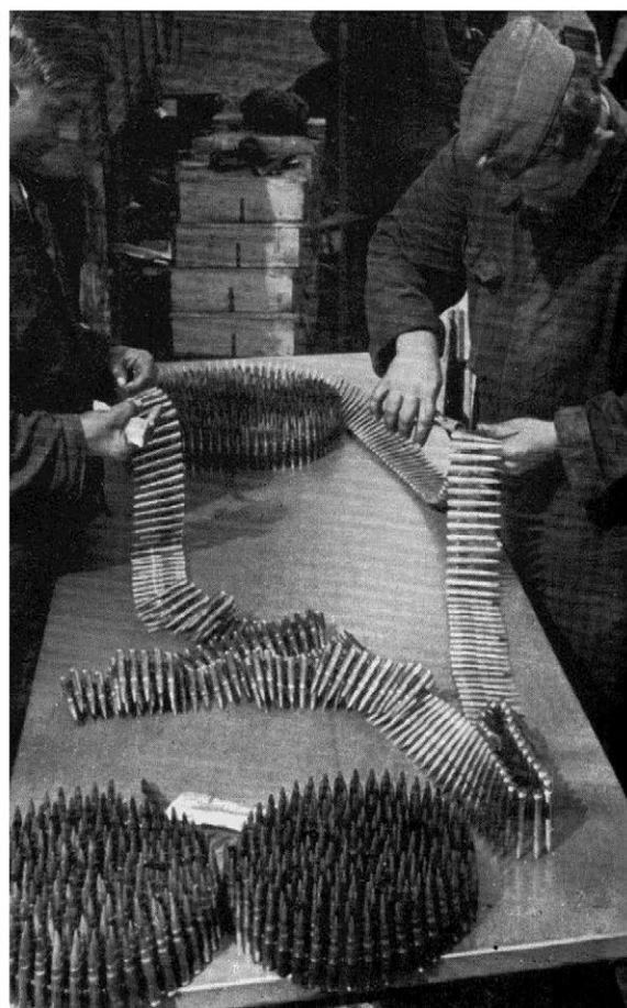
Ryc. 42. Nadma, stan. 12, gm. Radzymin, woj. mazowieckie. Uzbrojenie samolotu Messerschmitt Bf 110 B. (1) schemat rozmieszczenia broni pokładowej i amunicji we wnętrzu maszyny; (2) załadunek bębnow magazynów do działek MG FF, kal. 20 mm; (3) taśmowanie amunicji do karabinów maszynowych MG 17, kal. 7,92 mm (fotografie ze zbiorów M. Rogusza)
