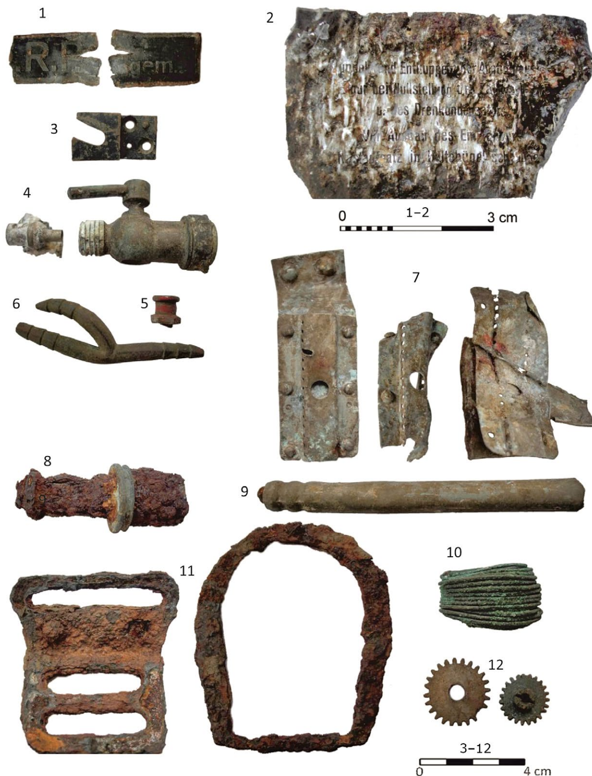
Ryc. 23. Nadma, stan. 12, gm. Radzymin, woj. mazowieckie. Elementy przyrządów pokładowych i wyposażenia Bf 110 B. (1) tabliczka z kokpitu (ar 1674); (2) tabliczka instrukcyjna, obsługa iskrowników ? (ar 1684); (3) część przełącznika zmiany skoku śmigieł ? (ar 1674); (4) zawór butli sprężonego powietrza ? (ar 1675); (5) przyłącze układu sprężonego powietrza ? (ar 1674); (6) trójnik instalacji sprężonego powietrza (obiekt 200 A); (7) mocowanie oprzyrządowania kokpitu ? (ary 2214, 2203, 1694); (8) zawór instalacji gaśniczej (obiekt 200 A); (9-10) rurka i mieszek ciśnieniowy przyrządów (obiekt 200 A); (11) klamry kabinowych pasów bezpieczeństwa (ary 1683, 1665); (12) koła zębate z przyrządów (ar 1694, obiekt 200 A)
