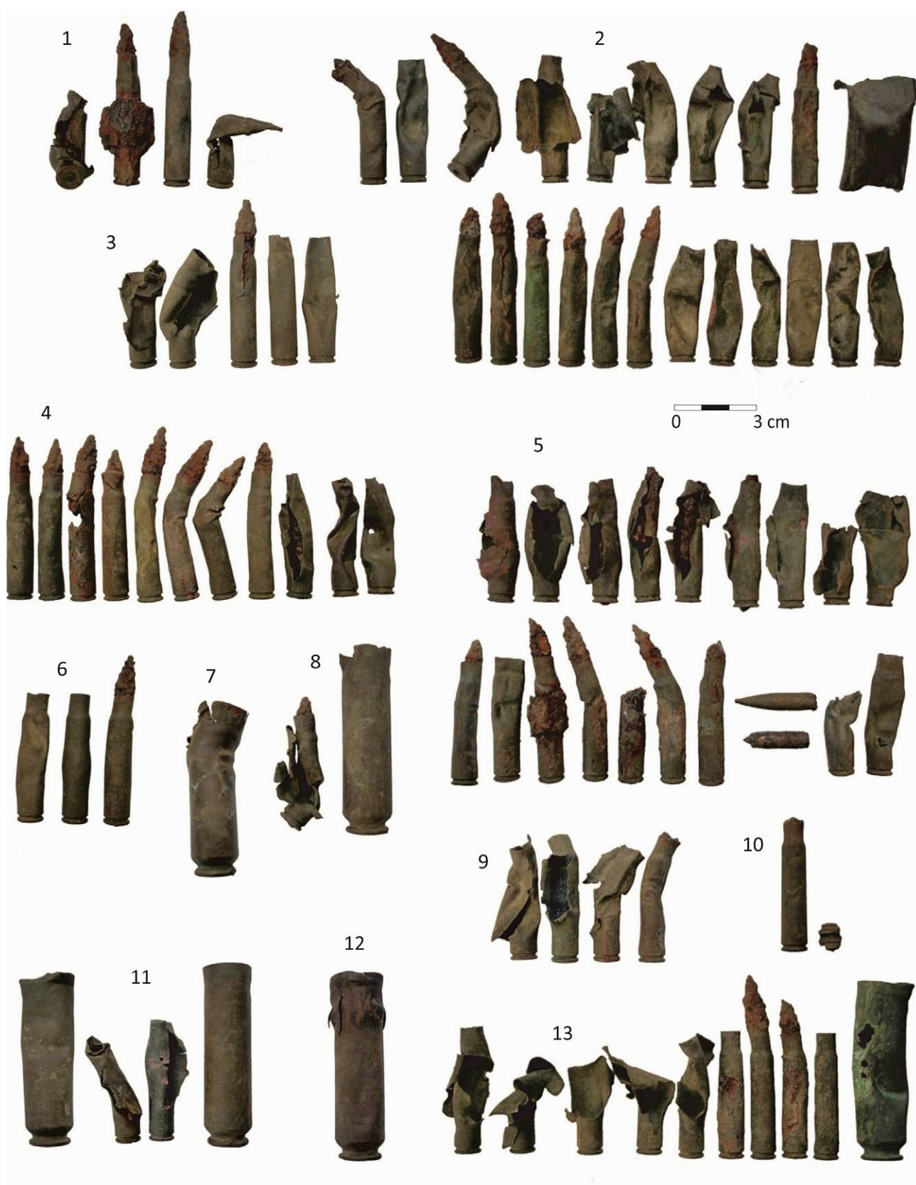
Ryc. 47. Nadma, stan. 12, gm. Radzymin, woj. mazowieckie. Destrukty lotniczej amunicji strzeleckiej 7,92×57 Mauser i 20×80 mm Oerlikon, znalezione w rejonie katastrofy samolotu Bf 110 B w humusie: (1) Ar 2214; (2) Ar 1654; (3) Ar 1675; (4). Ar 1674; (5) Ar 1664; (6) Ar 1665; (7) Ar 2202; (8) Ar 1673; (9) Ar 1685; (10) Ar 2205; (11) Ar 2205; (12) Ar 2243; (13) Ar 1684
