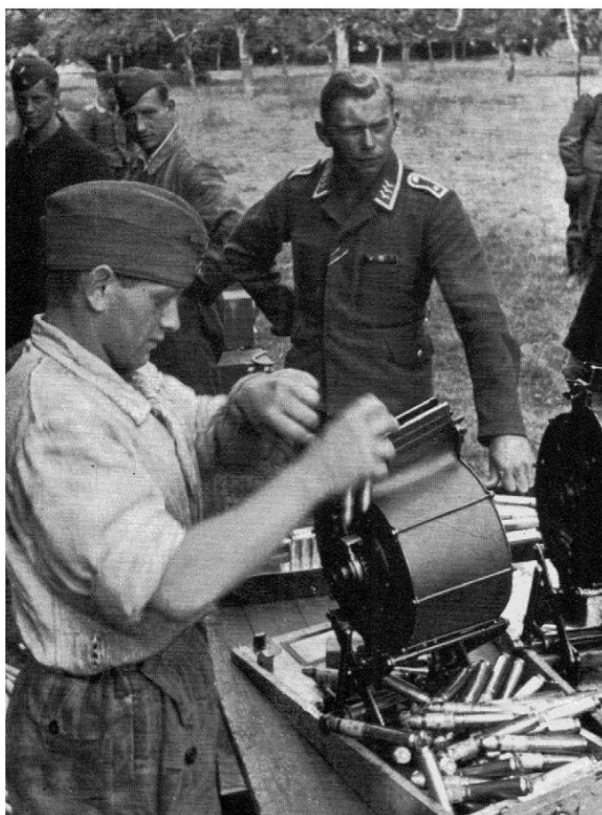
Ryc. 42. Nadma, stan. 12, gm. Radzymin, woj. mazowieckie. Uzbrojenie samolotu Messerschmitt Bf 110 B. (1) schemat rozmieszczenia broni pokładowej i amunicji we wnętrzu maszyny; (2) załadunek bębnow magazynów do działek MG FF, kal. 20 mm; (3) taśmowanie amunicji do karabinów maszynowych MG 17, kal. 7,92 mm (fotografie ze zbiorów M. Rogusza)
