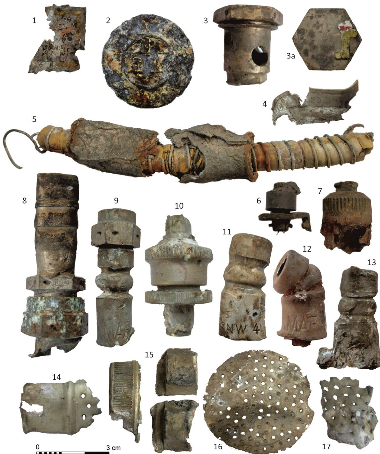
Ryc. 33. Nadma, stan. 12, gm. Radzymin, woj. mazowieckie. Elementy instalacji paliwowej samolotu Messerschmitt Bf 110 B. (1) tabliczka eksploatacyjna z odstownika paliwa (ar 1692); (2) trzpień z górnej części pompy paliwowej, sygnowany - „AP SUM” (ar 2204); (3) śruba odpowietrznika układu paliwowego silnika, na głbie śruby wybite logo Junkersa (ar 1673); (4) tabliczka znamionowa pompy (obiekt 200); (5) przewód paliwowy w oplocie z drutu i podwójnej izolacji (obiekt 200); (6-7) końcówki przewodów paliwowych (ary 1663, 1694); (8-10) złącza przewodów (ary 2204, 1693, obiekt 200); (11-13) okucia złączy przewodów paliwowych (ar 2213, obiekt 200 A, ar 1685); (14-17) fragmenty filtrów paliwa (obiekt 200)
