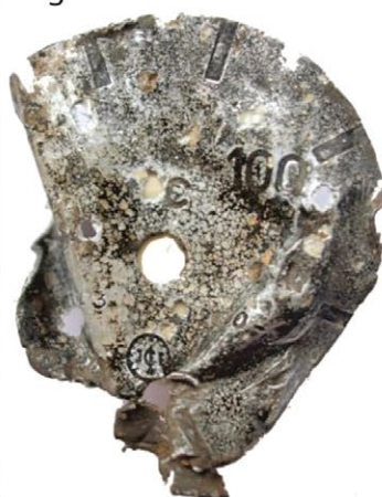
Flieg Triebwerksüberwachungsgeräte Doppel Dampfdruck – Thermometer FI 20330 Hersteller J.C.Eckardt A.G., Stuttgart-Cannst. Maximal App.-Fabrik, Berlin SW 61 Lieferer J.C.Eckardt A.G., Stuttgart-Cannst. Maximal App.-Fabrik, Berlin SW 61 Lieferungsgegenstand Doppel-Dampfdruck-Thermometer mit zwei Messstellen Messumfange: 0-10 bar (Eckardt), 0-10 bar (Maximal) Messbereich: 0 - 150° C Leistungslängen siehe Tabelle Einbauvorschrift Die Klemmenanschl. ( ) gelten für die von Maximal hergestellten Geräte. Maßstab 1:1
